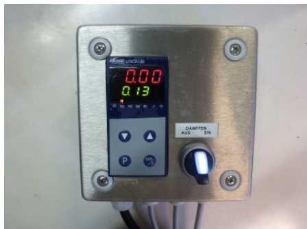
Abb. 6: Steuerung und Funktionsweise der Gegendruck-Ausrüstung von Clemens: Steuergerät (linkes Bild) und Druckarmaturen (rechtes Bild).
