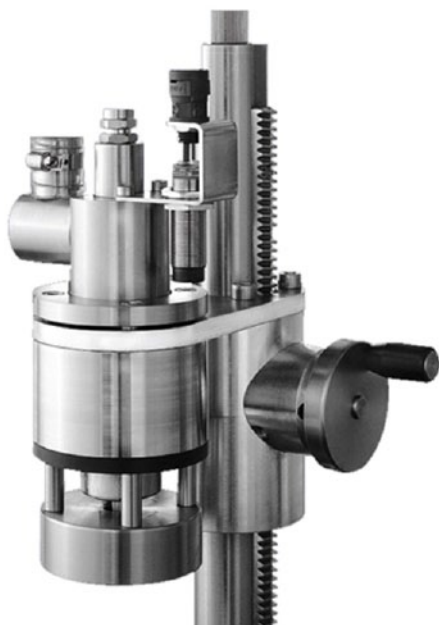
Abb. 3: Armatur für die Vorevakuierung der Flasche zur Minderung des O 2 Eintrags
