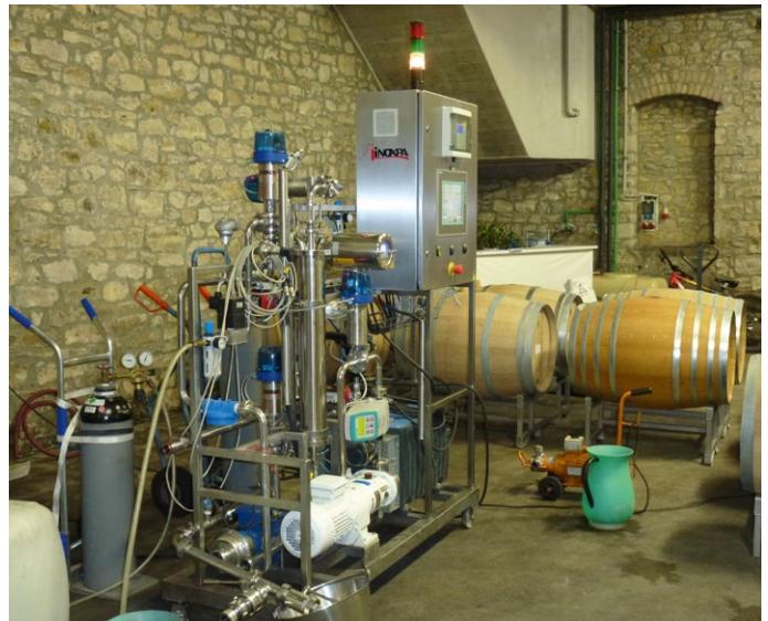
Abb. 7: Vollautomatischer Membrankontaktor „WineBrane“ (Fa. Inoxpa)
