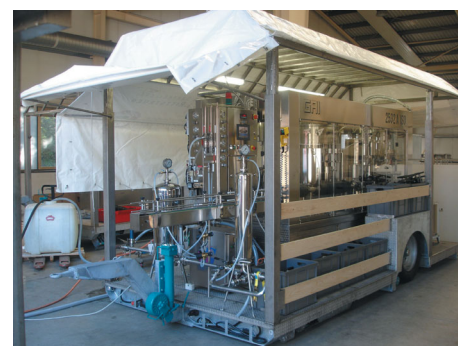
Rinser, Gegendruckfüller, Verschleißer finden auf einem mobilen Anhänger mit den Abmessungen 5200x2500 mm Platz
