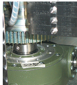
Abb. 7: Zentrale Schmierung erleichtert die Wartung
