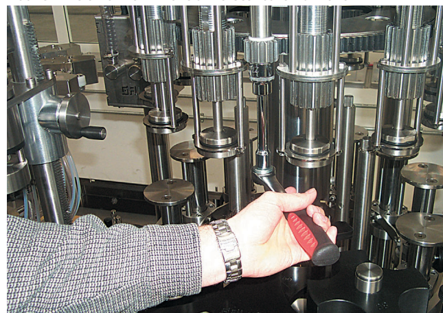
Abb. 3: Mit einem Griff zentral verstellbare Füllhöhe
