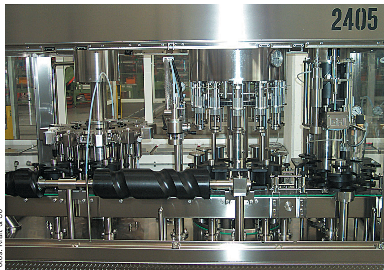
Abb. 1: Moderne Abfüll- und Verschlusstechnologie (GAI 2405 Top)
