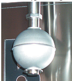
Abb. 5: Schwimmer zur Regulation der Pumpgeschwindigkeit
