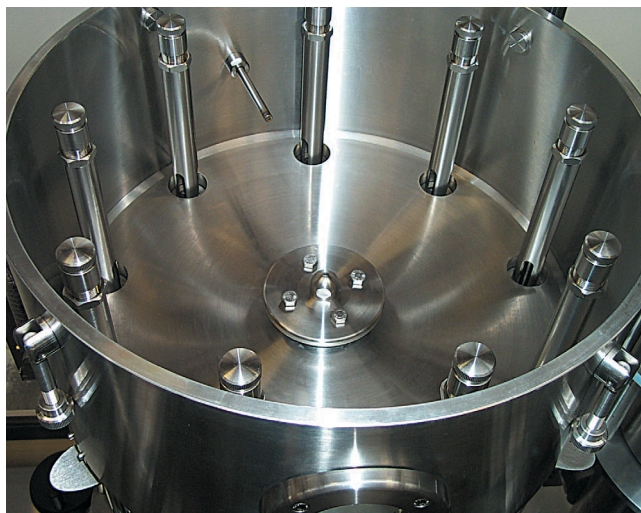
Abb. 4: Füllbehälter mit speziell versiegelter Oberfläche
